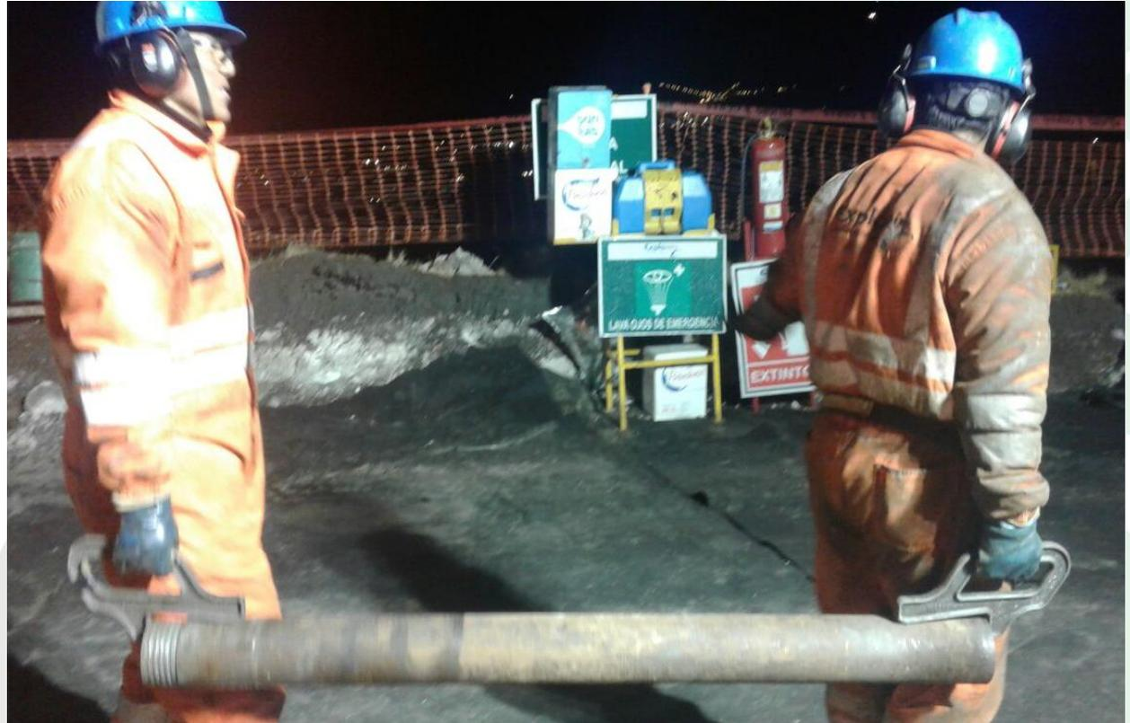
Uso de “ROD LIFTER”, para trasladar la tubería de perforación hacia el caballete, evita exponer manos a la línea de fuego.
